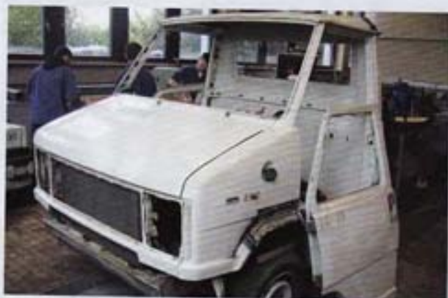
Schritt 1: Abbau der Zier- und Anbauteile von der Rohkarosserie des alten Citroën C25 Abschleppwagens, anschließend Einschweißarbeiten und Instandsetzung des völlig verrosteten linken Radlaufes.
