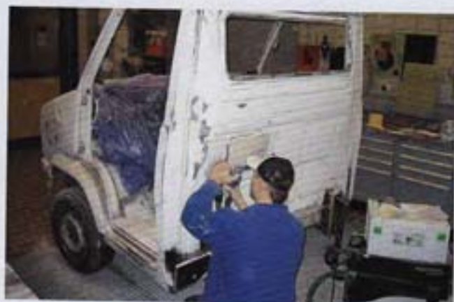
Schritt 2: Ausgleichen und Kitten diverser Unebenheiten an sämtlichen Bauteilen mit Spachtelmasse. Nach sorgfältiger Vorbereitung und Schleifarbeit wird der VDC-Systemfüller aufgetragen.
