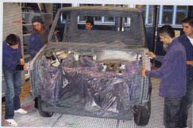
Schritt 3: Nach dem Schleifen des Füllers an der Karosserie sowie an sämtlichen Anbauteilen werden Karosserie- und Anbauteile innen mit Metallic-Basislack und 2K-Klarlack lackiert.
